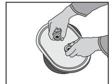
Die Drehgriffe bis Anschlag herausdrehen und den Deckel etwas verdreht in die Öffnung einschieben. Dann gerade drehen und leicht gegen den Kanal drücken (er positioniert sich automatisch richtig). Drehgriffe fest anziehen.
