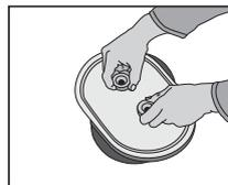
Drehgriffe bis Anschlag herausdrehen und den Deckel etwas verdreht in die Öffnung einschieben. Gerade drehen und leicht gegen den Kanal drücken. Drehgriffe fest anziehen.
